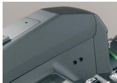
La K-7 dispone di microfono e altoparlante integrati.
