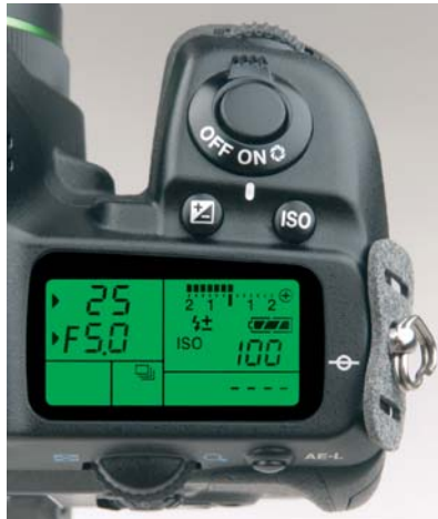
Il display di stato sulla calotta, dalla retroilluminazione verde brillante e intensa, consente di usare la macchina senza ricorrere al monitor posteriore.
