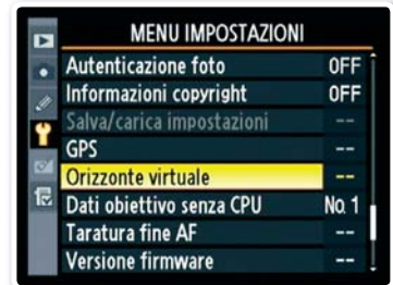
Con le focali ultragrandangolari - ma non solo - è fondamentale avere la fotocamera perfettamente in bolla; macchine come la Nikon D700 incorporano una livella a bolla virtuale
