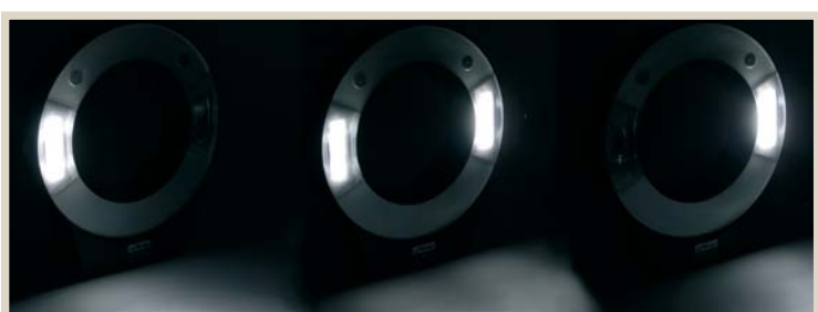
Un esempio di ripartizione del lampo tra le due parabole.
